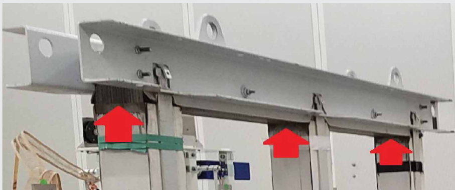
รูปที่ 2 ภาพแสดงส่วนต่อแกนเหล็ก (butt joint)
