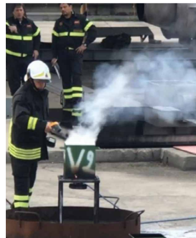
รูปที่ 2 แสดงการเกิดไอน้ำบวมของเอสเทอร์ธรรมชาติที่อุณหภูมิ 160 °C
