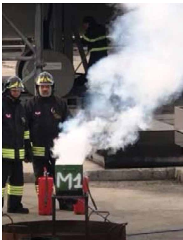
รูปที่ 1 แสดงการเกิดไอน้ำบวมของน้ำมันแร่ที่อุณหภูมิ 120 °C
