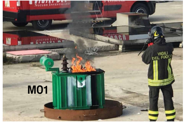
รูปที่ 5 แสดงการติดไฟของหม้อแปลงน้ำมันแร่ MO1 เมื่อเริ่มเผาไหม้หลังจากเวลา 34 นาที
