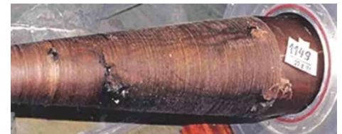
รูปที่ 7 แสดงความเสียหายของบุชชิงจากความชื้น
