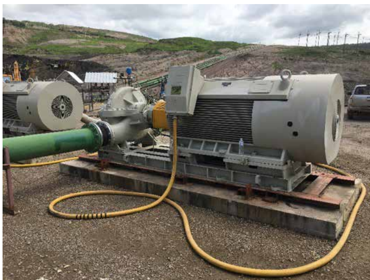
รูปที่ 7 มอเตอร์ 1,400 kW / 6,600 V สำหรับระบบสูบน้ำที่ใช้ในการทดสอบ
