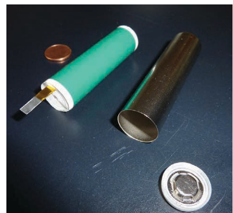
เซลล์แบตเตอรี่ลิเทียมไอออนพานาโซนิค 18650 ทรงกระบอกก่อนทำการประกอบ
