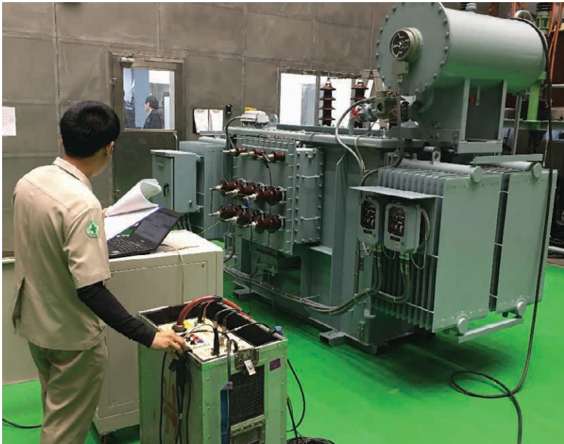
รูปที่ 8 หม้อแปลงออกแบบพิเศษ 22/6.6/0.69 kV / 1,500 kVA โดย บมจ.ทิสไทย ทดสอบร่วมกับชุดชดเชยกำลังงานรีแอกทีฟ โดย บจก. เพาเวอร์ควอลิตี้ ทีม จำกัด สำหรับมอเตอร์ 6.6 kV / 1,400 kW ณ ห้องทดสอบหม้อแปลง บมจ. ทิสไทย โรงงาน 3
