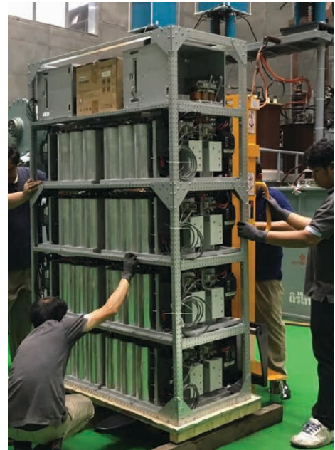
รูปที่ 8 หม้อแปลงออกแบบพิเศษ 22/6.6/0.69 kV / 1,500 kVA โดย บมจ.ทิสไทย ทดสอบร่วมกับชุดชดเชยกำลังงานรีแอกทีฟ โดย บจก. เพาเวอร์ควอลิตี้ ทีม จำกัด สำหรับมอเตอร์ 6.6 kV / 1,400 kW ณ ห้องทดสอบหม้อแปลง บมจ. ทิสไทย โรงงาน 3
