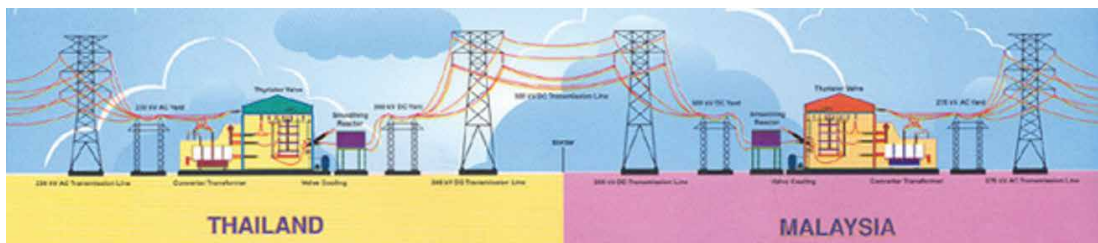
รูปที่ 13 - แสดงสายส่งเชื่อมต่อระหว่างสถานีไฟฟ้าแรงสูงคลองแงะ ประเทศไทย กับ สถานีไฟฟ้าแรงสูงกรุงน ประเทศมาเลเซีย
