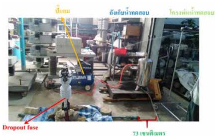
รูปที่ 10 ลักษณะและตำแหน่งน้ำที่ตกลงบนดรอพเอาต์ฟิวส์ในการทดสอบ
