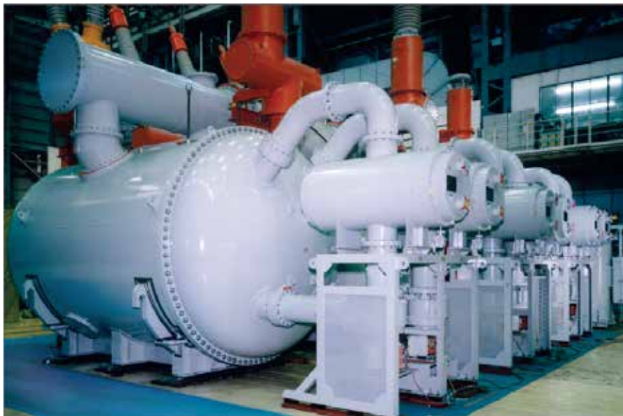
รูปที่ 7 แสดงการทดสอบหม้อแปลงฉนวนก๊าซ SF 6 ที่ห้องทดสอบของผู้ผลิต
