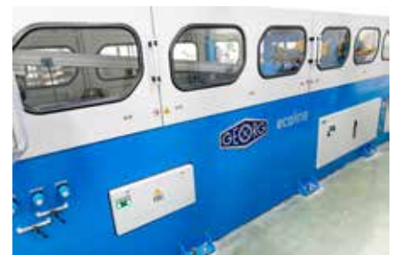
ภาพระบบป้องกันสายการผลิตขณะเครื่องตัดทำงาน
