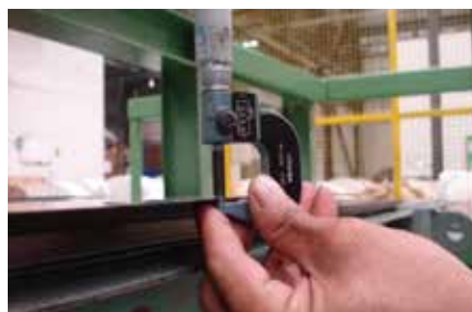
ภาพการวัดค่า Burr แผ่นเหล็กซิลิคอน
