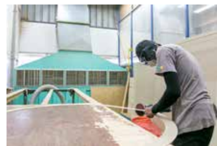
ภาพการทำงานในห้องที่ติดตั้งระบบบำบัดอากาศ Bag House Filter
