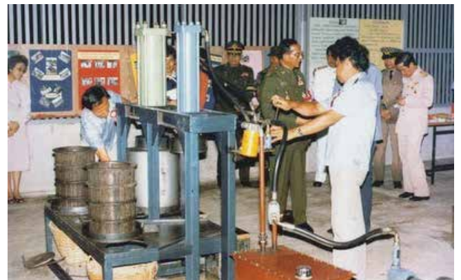
รูปที่ ๑๘. โรงงานแอลกอฮอล์ซึ่งมีทั้งเครื่องหีบอ้อย ถึงหมัก หากลั่นขนาดเล็ก
