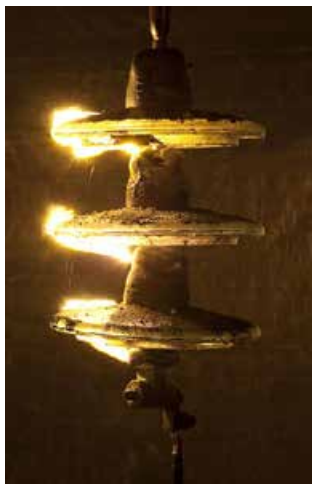
รูปที่ 3: แสดงการเกิด puncture ลูกถ้วยฉนวน
