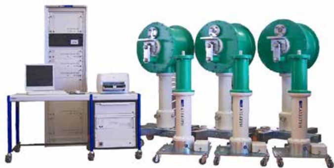
รูปที่ 8. Transformer Measuring System
