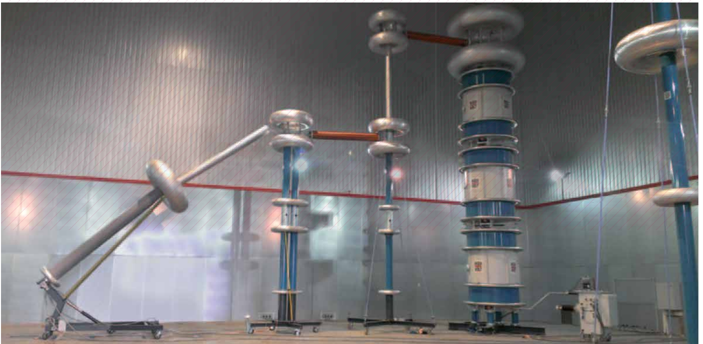
รูปที่ 11. แสดงห้องทดสอบระบบชิลด์ฟาราเดย์
