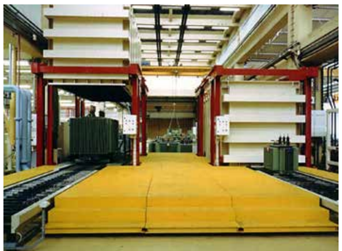
รูปที่ 16 ตัวอย่างระบบการอบแห้งโดยใช้กระแสไฟฟ้าความถี่ต่ำ
