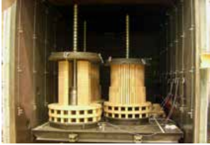
รูปที่ 10 อุปกรณ์ที่ใช้ในการทดสอบคอยล์ภายในเตาอบในช่วงที่มีการอบคอยล์
