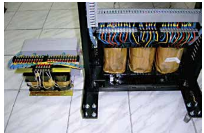
รูปที่ 6: เปรียบเทียบหม้อแปลงสำหรับระบบเรียงกระแส แบบ 18 พัลส์ที่อัตรากำลังเท่ากันโดยด้านซ้าย เป็นหม้อแปลงแบบออตโตและด้านขวาเป็นแบบ ซิกแซก
