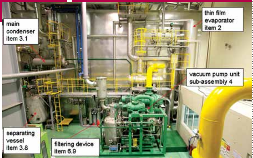
รูปที่ 6 เตาอบ Vapour phase ที่ใช้อิวาพอเรเตอร์แบบทินฟิล์ม ออกแบบโดยบริษัท Hedrich ประเทศเยอรมนี
