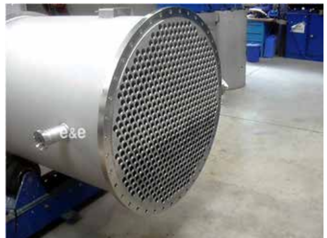
รูปที่ 5 ฐานด้านล่างของอีวาพอเรเตอร์แบบทินฟิล์มที่แสดงให้เห็นถึงท่อขนาดเล็กจำนวนมาก
