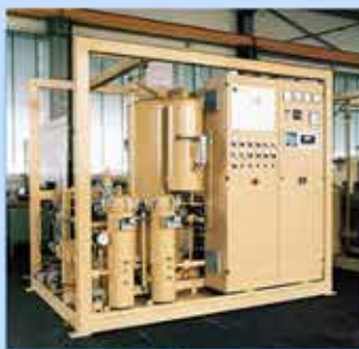
เครื่องกรองน้ำมันหม้อแปลง ระบบ INDIRECT OIL-PURIFICATION
