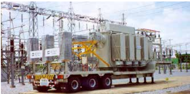
▶ หม้อแปลงไฟฟ้า Mobile Substation ขนาด 15/20/25 MVA 115 kV
