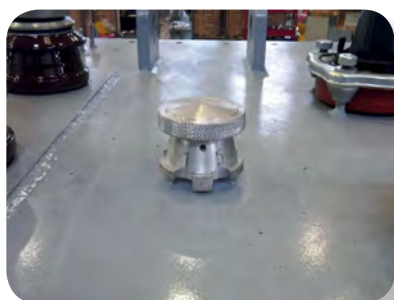
รูปที่ 2 ตำแหน่งติดตั้งอุปกรณ์ Off circuit tap changer กับหม้อแปลงขณะที่ผลิตรายงาน
