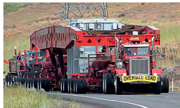
รูปที่ 7 การขนส่งหม้อแปลงกำลัง น้ำหนัก 254.5 ตัน
