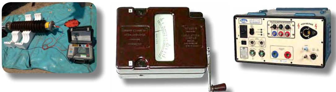
เครื่องมือวัด Insulation resistance และเครื่องมือวัด Power Factor
