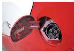
ช่องเสียบสายชาร์จไฟฟ้าระบบปกติและระบบชาร์จเร็ว
