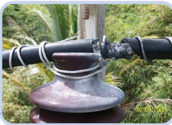
ภาพที่ 4 สาย SAC เสื่อมสภาพ และอาจเกิดเหตุการณ์สายขาดในลำดับต่อมาได้
