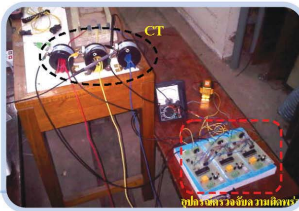
ภาพที่ 11 อุปกรณ์ตรวจจับความผิดปกติ ที่ต่อร่วมกับระบบจำหน่ายไฟฟ้าจำลอง
