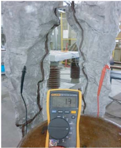
รูปที่ 1 กางเกงสำหรับป้องกันอันตรายจากกระแสไฟฟ้ารั่ว
