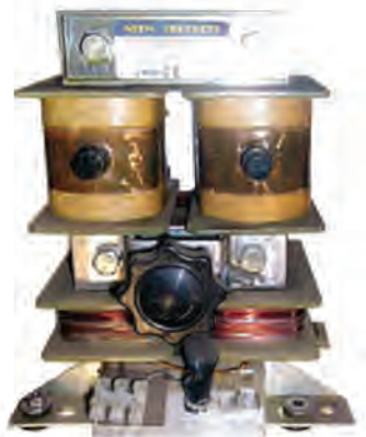
หม้อแปลงแบบอินดักแทนซ์รั่วไหล
