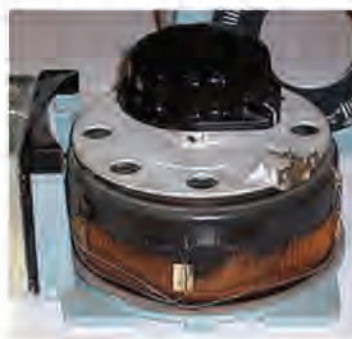
หม้อแปลงไฟฟ้าแบบออโต้
