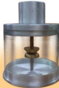
รูปที่ 4 การติดตั้งอิเล็กโตรดเข้ากับเซลล์ทดลอง
