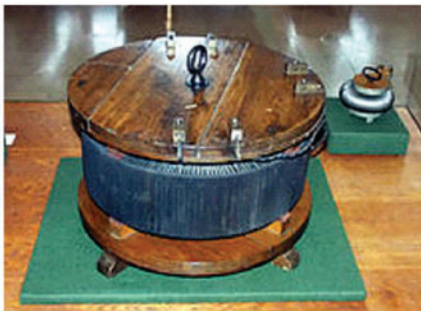
หม้อแปลงต้นแบบที่มีประสิทธิภาพสูง ตัวแรกของโลก ซึ่งสร้างโดยทีม Z.B.D. ในปี 1884
